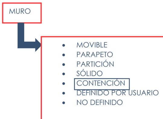
Fig. 3 – En el esquema IFC BRIDGE, actualmente en proceso de revisión, la entidad general muro puede especificarse directamente según el listado de los tipos más utilizados (TypeEnum), pues en esta versión se incorpora el tipo de muro de CONTENCIÓN.
