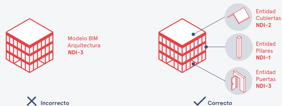
Figura 5. Simultaneidad de distintos NDI de las entidades en un modelo BIM
