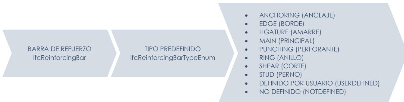
Fig.4 – Tipos predefinidos de Barra de Refuerzo (IfcReinforcingBar)
