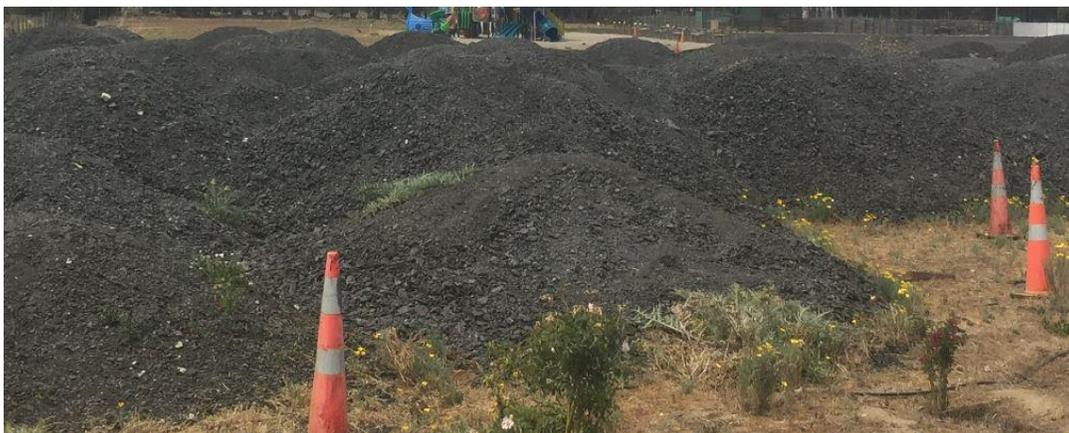
**Ilustración 4: Acopio de material reciclado para pavimentos asfálticos, región de Valparaíso.**
