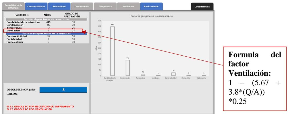
Figura 25: Pestaña obsolescencia en el Modelo que muestra el valor de la Ventilación
