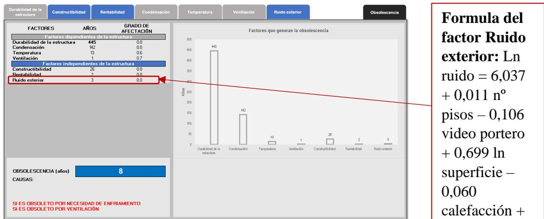
Figura 21: Pestaña obsolescencia en el Modelo que muestra el valor del Ruido exterior
