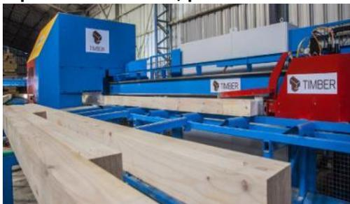
La empresa **Timber** ubicada en Lautaro, utiliza tecnología CAD-CAM en su proceso de fabricación cuenta con maquinaria de control numérico (CNC) que le permite elaborar cada elemento con todos los ajustes necesarios para el ensamblaje y unión con el resto de la estructura de tal forma que se minimizan los trabajos en obra. Cada elemento lleva una numeración que permite localizarlo en todo momento.
