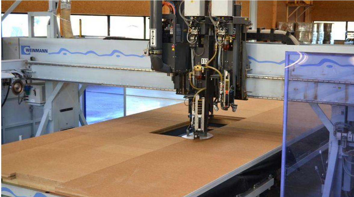
Figura 7.13. Sistema automatizado, controlado por ordenador, de corte de Madera Contralaminada.
