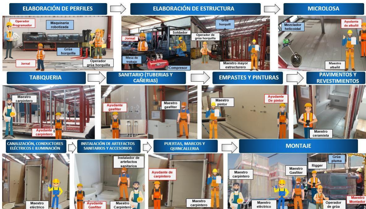
Figura 3: Mapa de proceso prefabricación de salas de baño modular para edificaciones tradicionales en altura.
