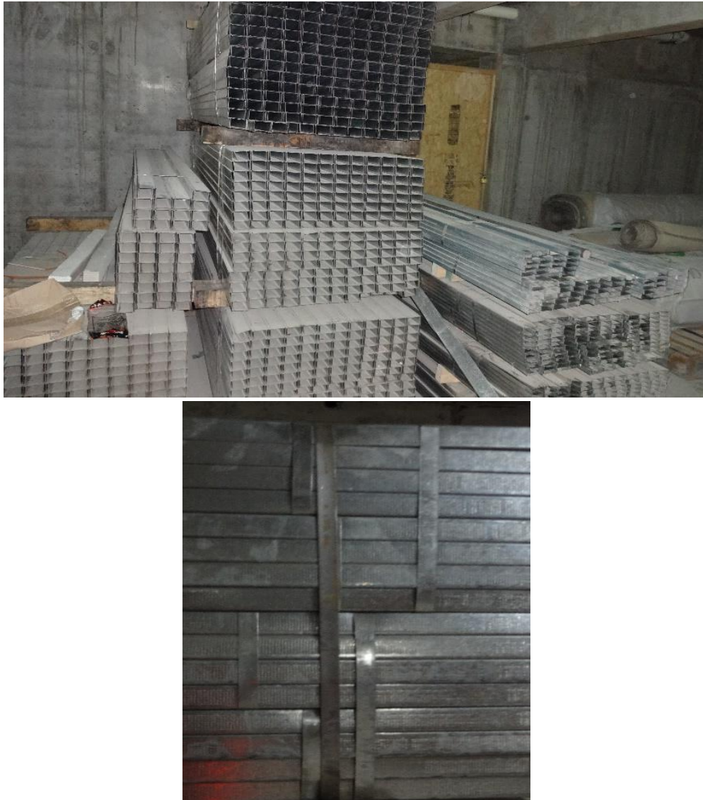
Figura 18: PERFIL TABIGAL MONTANTE Y CANAL (MDC0001 – MDC0344)
