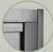
La **ESTRUCTURA** de la puerta Turia Doble Sentido está formada con 2 planchas de **acero galvanizado** de 0.8 mm de espesor, ensambladas sin soldadura y con protección antifinger. Su **espesor es de 63 mm**, con un solape de 32.5 mm de ancho y 2 mm de espesor.
