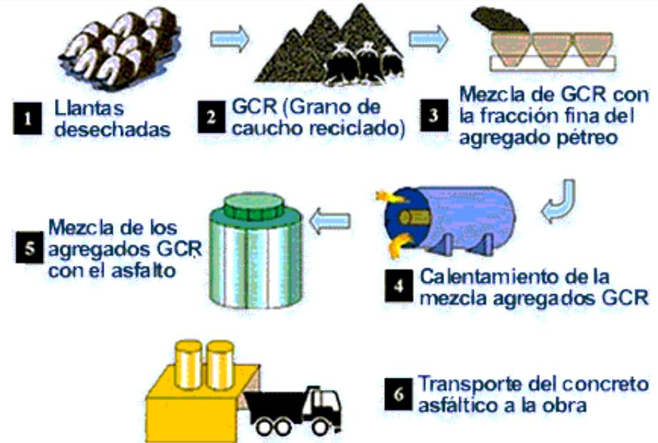
Fabricación de Asfalto con Caucho, vía Húmeda
